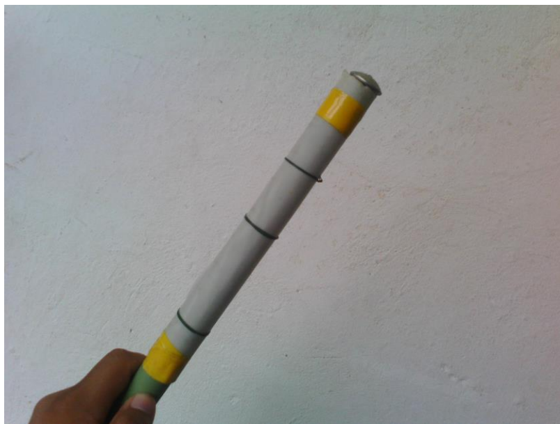
Figura 12 Instalación de malla filtro en piezómetro.
