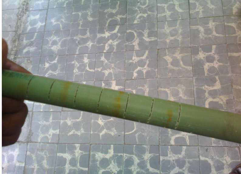
Figura 11 Ranuras en tubo de PVC
