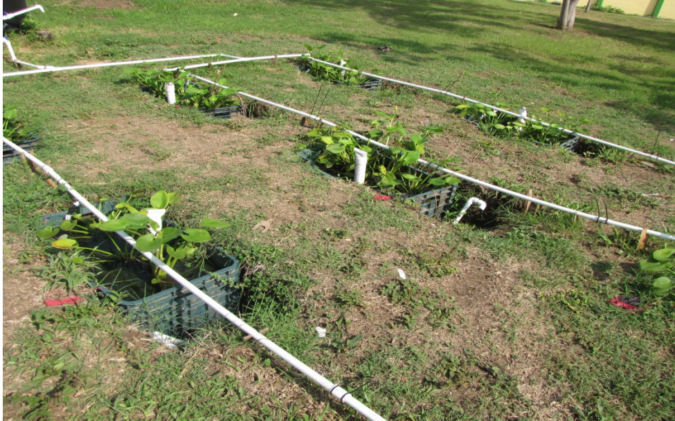
FIGURA 2.3. Celdas de Combustible Microbiano de Sedimento Planta (CCMSP) utilizadas para el experimento dos, especie hidrófita: Pontederia sagittata .
